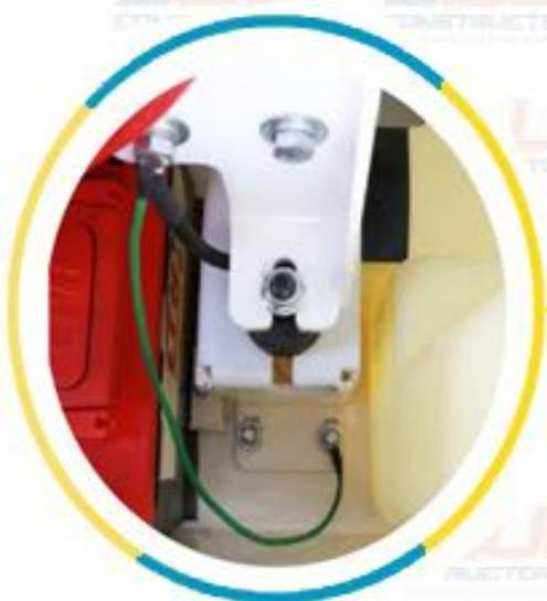
Revisar el cableado, que no esté machucado, dañado, ni pelado.
